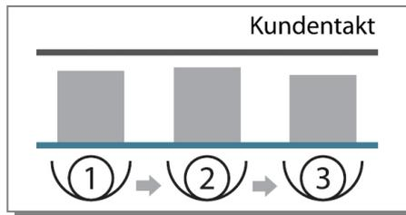
Standardisierte Arbeit bedeutet, dass wiederkehrende Arbeitsabläufe systematisch und einheitlich durchgeführt, standardisiert und ständig verbessert werden, um hohe Qualität und Produktivität zu gewährleisten. Die standardisierten Arbeitsprozesse sind über qualitativ hochwertige Tätigkeitsbeschreibungen abzubilden. Diese schaffen die Grundlage, um neue Mitarbeiterinnen und Mitarbeiter mit TWI (Training Within Industry) direkt
